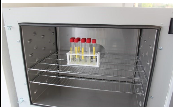
7.13 반응용기(Reaction vessels)를 건조기에 넣는다.
