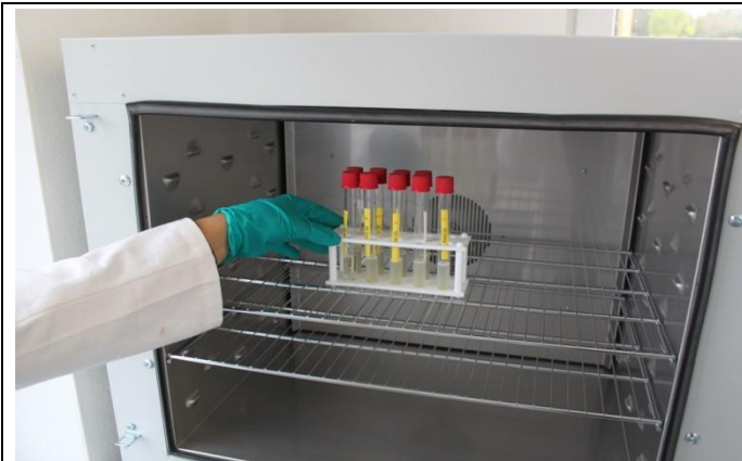
7.13 반응용기(Reaction vessels)를 건조기에 넣는다.
